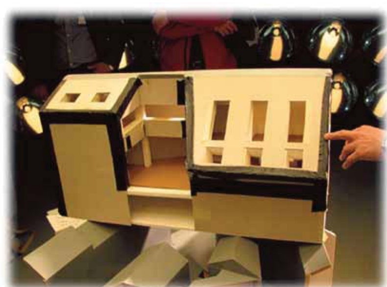
Slika 3 V laboratoriju dnevne svetlobe na Donau-Universität Krems so na modelu merili spreminjanje osvetljenosti prostorov za celo leto
