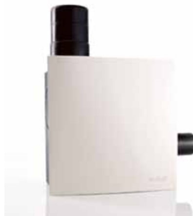
Slika 7 Splakovalniki so opremljeni s prezračevalnim priključkom DN50, na katerega se priključi prezračevalna cev. Za povezavo ter med splakovalnikom in ventilatorjem ter med ventilatorjem in prezračevalno vertikalo se lahko uporabljajo cevi PP, TRIPLUS, PEHD ali PVC. Za vgradnjo enega ali dveh stranišč z Ariapurjem ni težav, zadošča vertikala DN100. Pri večjem številu pa je potrebno preveriti dimenzijo fekalne vertikale
