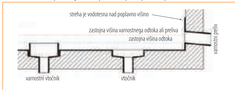
Slika 19 Namesto varnostnih prelivov je možno predvideti prostopadni ali podtlačni varnostni sistem
